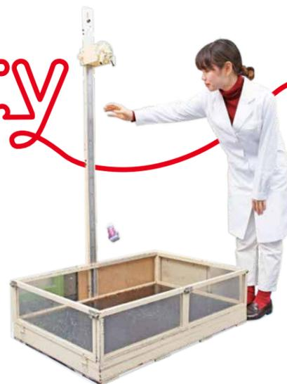
玩具を落下させる衝撃試験。落としてしまったときに破片で怪我をしないよう、危険な箇所がないか確認します。
