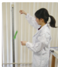
玩具を落下させる衝撃試験
